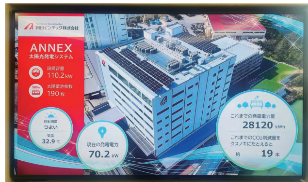
屋上に設置した太陽光発電システムの発電電力をリアルタイムで表示するパネル
