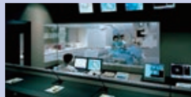
カテーテル手術のシミュレーション室 四方の壁と天井に鉛板を仕込むことで、周囲にX線が漏れることを防ぎます。
